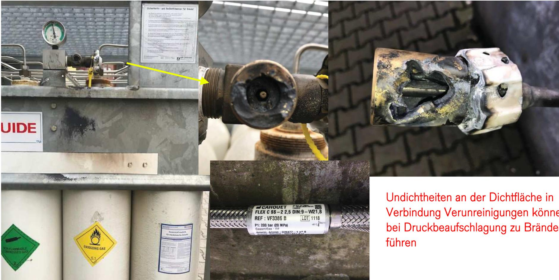
Undichtheiten an der Dichtfläche in Verbindung Verunreinigungen können bei Druckbeaufschlagung zu Bränden führen
