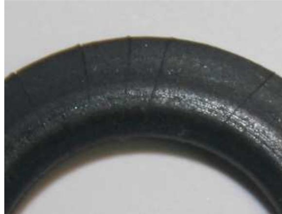
Dichtung werden mechanisch und chemisch beansprucht.
