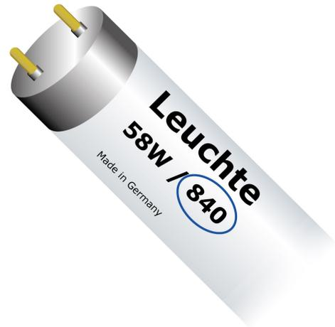
Kennzeichnung der Lampen hinsichtlich Farbwiedergabe und Lichtfarbe durch dreiziffrigen Code. Aus BGI 856 Beleuchtung im Büro aus 10-2008
