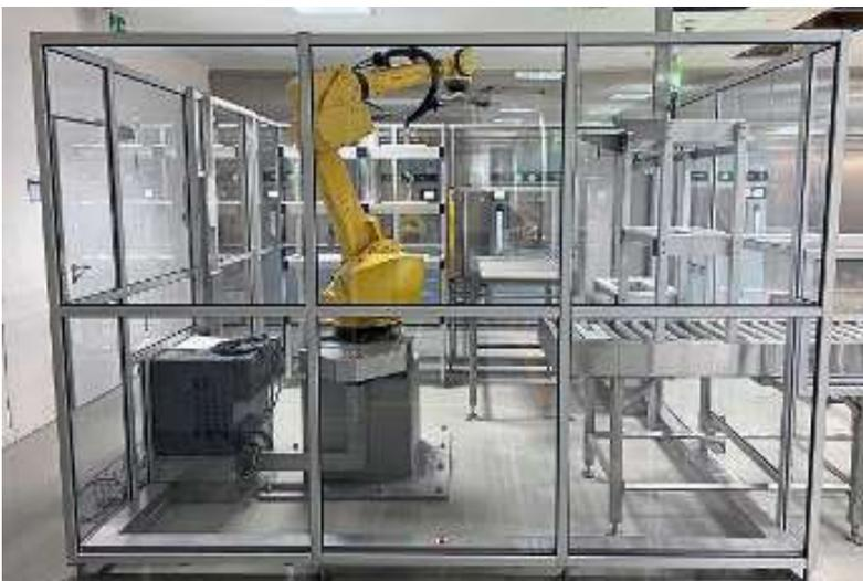
Sicherheit war bei der Einführung des Systems ein wichtiges Thema. Um Mitarbeitende nicht zu gefährden, sind die stationären Roboter in abgeschlossenen Plexiglasskabinen untergebracht.
